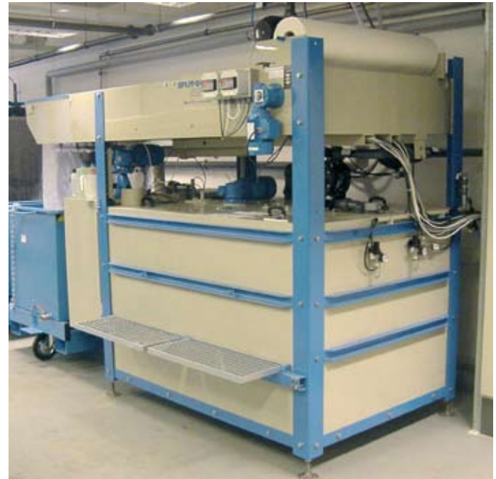
Serielle Abwasserbehandlungsanlage Split-O-Mat® 3000 für Abwässer aus der Produktion von Kartonagen und Verpackungsmaterialien
