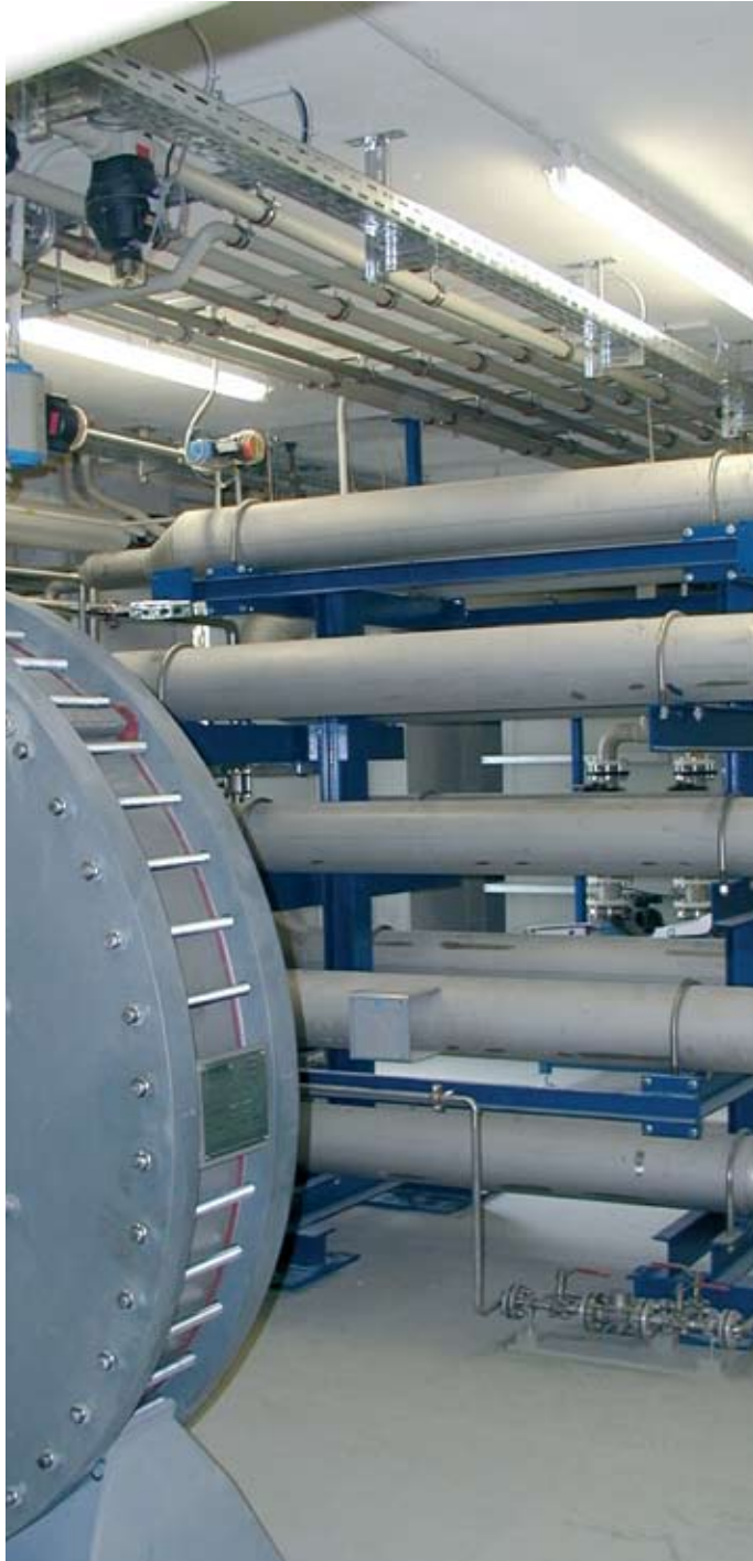
Spezieller DTS Spiralwärmetauscher mit Verweilstufe 3m 3 /h
