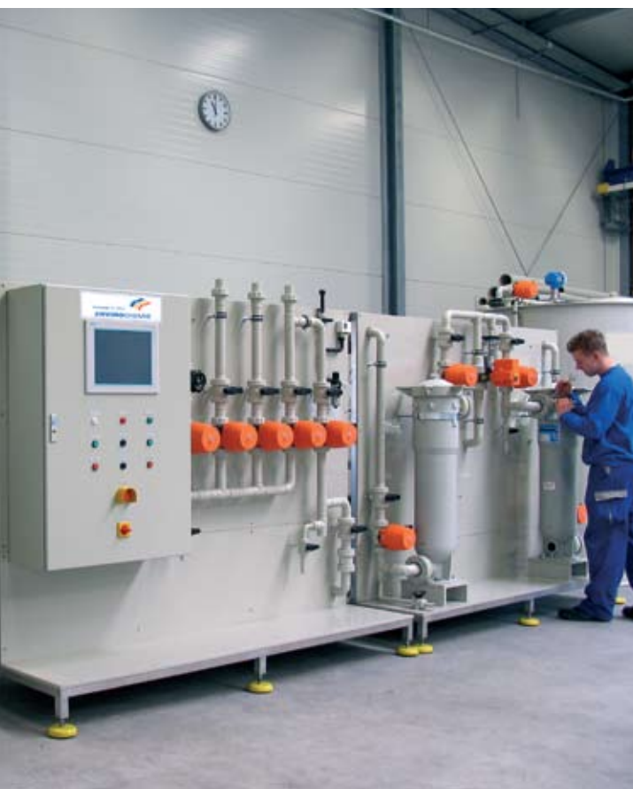
Teilansicht der APU Säureregeneration bei der Vormontage bei EnviroChemie in Rossdorf
