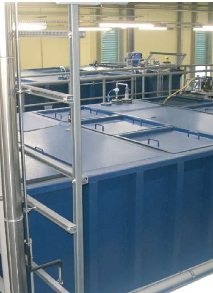
Teilansichten der Envochem® COL 30.000 Anlage zur Aufbereitung öl- und schwermetallhaltiger Waschwässer aus der Wäsche von Putztüchern
