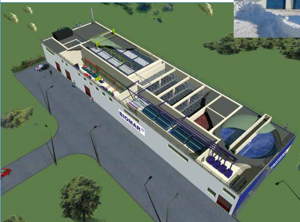
Mehrstufige biologische Abwasserbehandlungsanlage BIOMAR® für eine Brauerei Multi-stage biological waste water treatment plant BIOMAR® for a brewery
